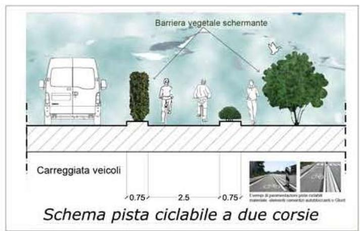
Fig 1.11 Schema pista ciclabile a due corsie. - Tav D.a.1
