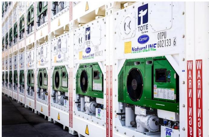
Le unità NaturaLINE utilizzano un refrigerante di CO<sub>2</sub>, noto anche come R-744, che ha un potenziale di riscaldamento globale ultra basso di 1, in confronto ai potenziali di riscaldamento globale che spaziano da 600 a circa 4.000 per i refrigeranti utilizzati in altri sistemi containerizzati.
