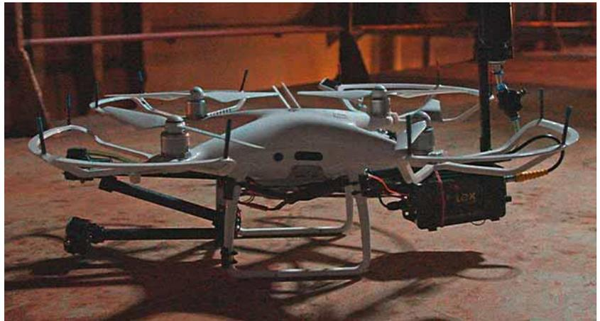
Oggi possiamo dire che abbiamo la capacità di offrire agli armatori il pacchetto completo di servizi di ispezione a distanza assistiti da droni compresa l’ispezione da vicino e la verifica delle misurazioni di spessore”.
