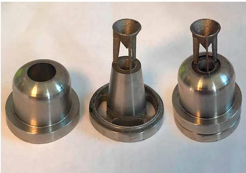
La complessa geometria dell'ugello per gas inerti (al centro), che si inserisce nella capsula (a sinistra; entrambe le parti assemblate a destra) può essere prodotta solo utilizzando la Fusione Laser Selettiva, un processo di produzione additiva.
